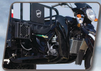
ระบบระบายความร้อน ด้วยหม้อน้ำ
