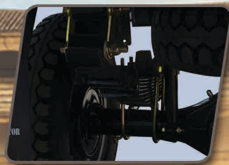
รับน้ำหนักได้มากขึ้น ด้วยแหนบ 7 ชั้น
